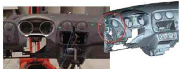
紅圈部分測得異聲。圖片由Applus IDIADA提供。
